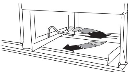
Otočte vyvažovací nástroj doprava o dvě celé otáčky (180°). Otáčení půjde ztěžka. Během spuštění rolny se přední část vařiče lehce nadzvedne.
