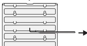
Zvedněte přední část regálu tak, aby zadní část regálu prošla pod zarážkou, a potom regál vysuňte.
