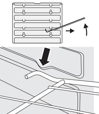
Aby włożyć wkład do piekarnika należy przyłożyć go w miejscu gdzie na ściankach piekarnika znajduje się specjalny rowek, dosunąć wkład do tylnej blokady, a następnie podnieść przód wkładu tak, aby koniec półki znalazła się przy blokadach i w końcu należy opuścić wkład do pionu i dosunąć do końca.
