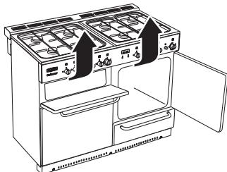
Aby przemieścić kuchnię, zaleca się otworzenie drzwi grilla i prawego piekarnika, co pozwoli mocno chwycić spód panelu kontrolnego kuchni. Należy podnieść do góry przód kuchni i pociągnąć do przodu.
