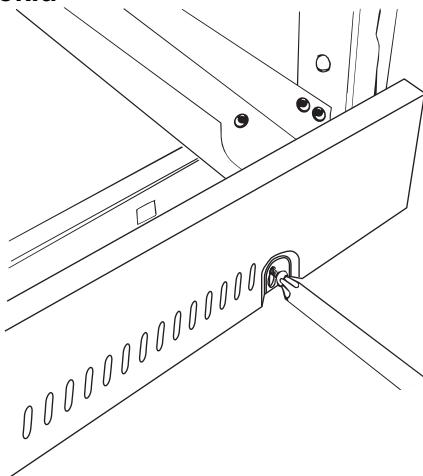
Povolte 3 šrouby podél předního dolního okraje vařiče. Nasadte středový otvor na středový šroub. Nasadte a připevněte oba koncové otvory na příslušné šrouby. Utáhněte upevňovací šrouby.
