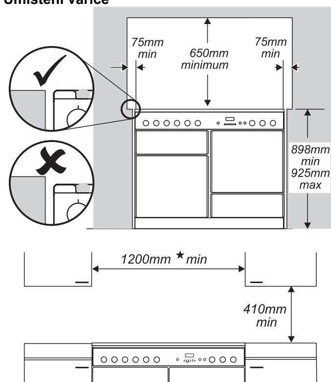
Na obrázcích jsou uvedeny minimální doporučení vzdálenosti vařiče od okolních ploch.
