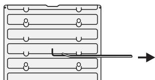
Następnie należy podnieść przód wkładu do góry tak, aby jego tył przeszedł pod blokadą i pociągnąć wkład do siebie.
