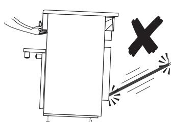
Po přemístění otočte vyvažovací nástroj doleva, aby se vařič spustil z rolen. To je důležité. Vyvažovací nástroj zabraňuje náhodnému posouvání vařiče během používání.
