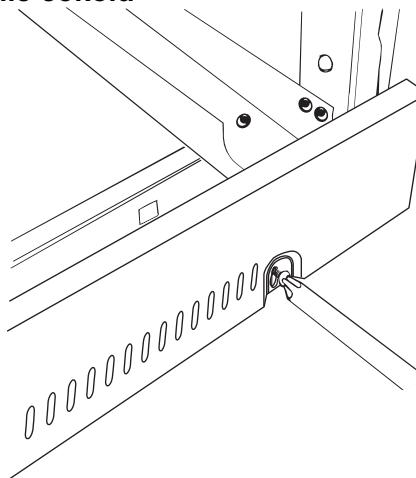
Należy odkręcić 3 śruby znajdujące się wzdłuż dolnej przedniej krawędzi kuchni, następnie przyłożyć centralny otwór cokołu i umocować w nim śrubę, a na końcu dokręcić śrubę.
