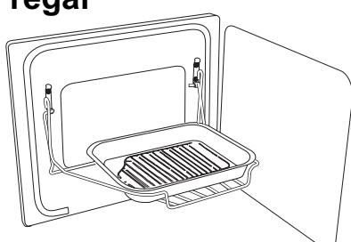
Příruční regál lze připevnit pouze na levá dvírka trouby. Maximální nosnost příručního regálu je 5,5 kg. Je určen pouze pro zakoupené masové konzervy, které jsou pro tento regál určeny. Jiná nádoba by nebyla v regálu stabilní.
