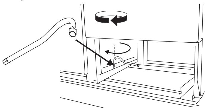
Kiedy wysokość i ustawienie są odpowiednie, prosimy unieść przód kuchenki jednym obrotem urządzenia nastawczego do regulacji przedniej rolki.
