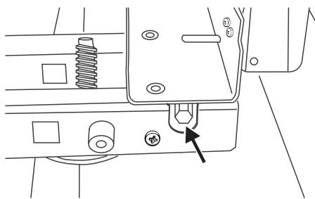
Upravením výšky předních rolen vařič vyvažte. Otáčením doprava vařič zvedáte; otáčením doleva vařič spouštíte.
