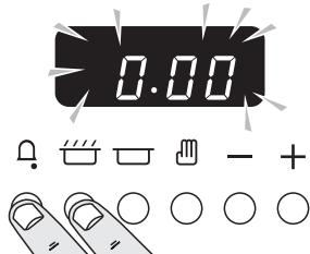
Stiskněte a podržte tlačítka podle obrázku. Současně opakováním stisknutím tlačítka (-) nebo (+) nastavte přesný čas. Nezapomeňte, že se jedná o hodiny s 24hodinovým formátem. Pokud uděláte chybu nebo
