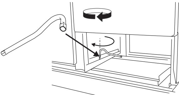
Po nastavení výšky a vyvážení zvedněte přední část vařiče jedním otočením nastavovadla přední rolny. Vyšroubujte přední nožku až na podlahu. Zašroubujte nastavovadlo přední rolny doleva tak, aby se přední rolna zvedla a aby se přední část vařiče opřela o nožku, nikoli o přední rolnu (aby nedošlo k náhodnému pohybu vařiče). Ponechte rukojet' vyvažovacího nástroje na nastavovadle směřovat k zadní straně vařiče, aby jej mohl zákazník použít v případě přemístování vařiče.
