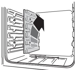
Po vyjmutí panelů je možné očistit lakovaný vnitřní povrch trouby.
