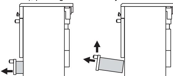
Je možné, že firma, která vařič instalovala, neumístila vyvažovací nástroj na příslušné místo. V opačném případě jej vyhledejte podle obrázků. Pokud vyvažovací nástroj nelze najít, obraťte se na firmu, která vařič instalovala. Viz začátek části Instalace tohoto návodu.
