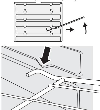
Chcete-li regál nasadit zpět do trouby, nasadte jej do drážky na boční straně trouby a zasuňte regál do trouby, dokud nenarazí na zarážku. Zvedněte přední část regálu tak, aby se konce regálu vysunuly ze zarážek. Potom sklopte přední část regálu tak, aby byl vodorovný a zcela zasunutý.
