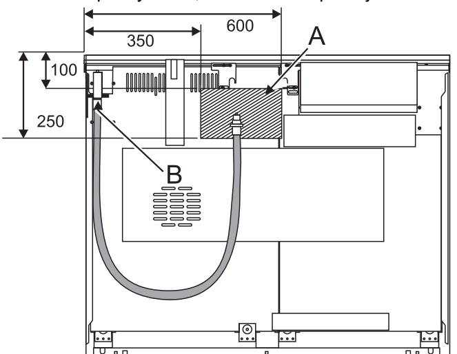
Kryty zadních skříněk omezují umístění plynové přípojky. Koncovka domácí plynové přípojky musí být orientována směrem dolů.
