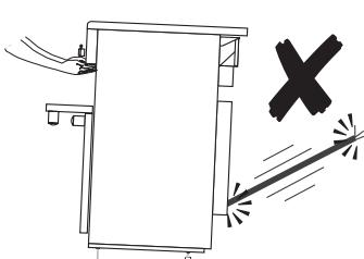
Jeżeli kuchnia jest dodatkowo przymocowana łańcuchem stabilizującym, należy odpiąć do podczas jej przemieszczania.
