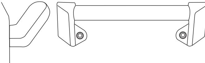
Odšroubujte imbus šrouby 4 mm z horních rohů ovládacího panelu a přišroubujte přední madlo.
